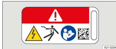
Fig. 5 Letrero de advertencia en componentes de alto voltaje.
